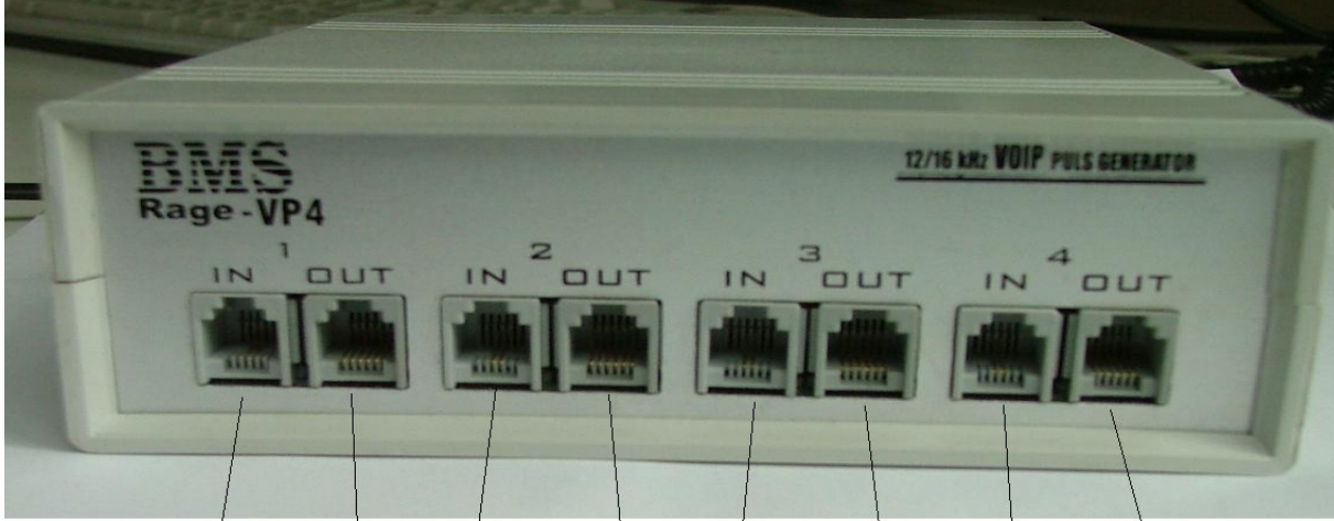
IN1 birinci hat girişi OUT1 birinci hat ve data çıkışı IN2 ikinci hat girişi OUT2 ikinci hat ve data çıkışı IN3 üçüncü hat girişi OUT3 üçüncü hat ve data çıkışı IN4 dördüncü hat girişi OUT4 dördüncü hat ve data çıkışı
